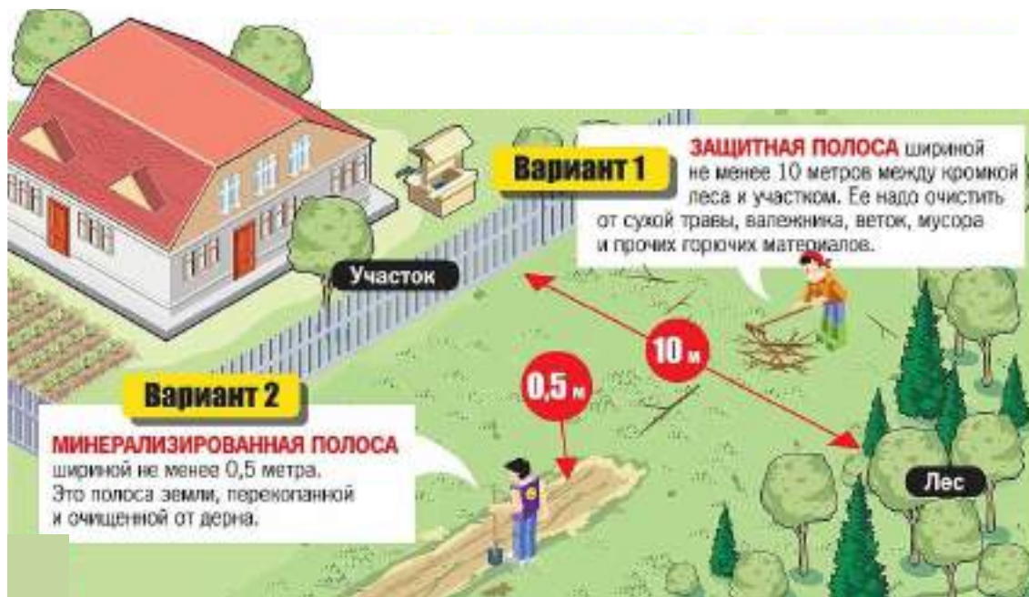
Рисунок 6.1.3. - Способы защиты жилых домов от лесных пожаров
